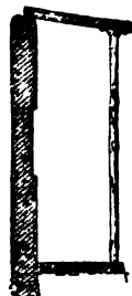
Toit de l'atrium ancien s'appuyant sur un mur avec niche; colonnette en maguey, reposant sur un trottoir.
